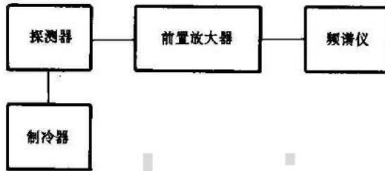
图 7 振动噪声测试系统框图
