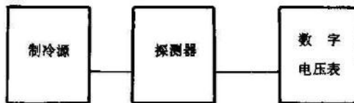
图5 制冷启动时间 ( t_1 ), 蓄冷时间 ( t_2 ) 测试框图
